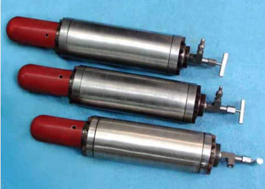
Figura 2. Recipientes de alta presión para conservación de muestras de fluidos presurizados.
