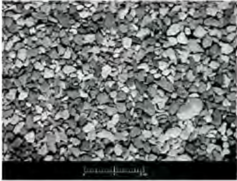
Figura 12. Recortes de perforación.
