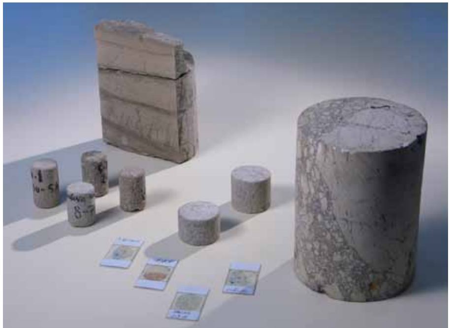
Figura 1. Muestras de roca del subsuelo. Las muestras pequeñas se extraen a partir de núcleos o coronas de mayor diámetro.
